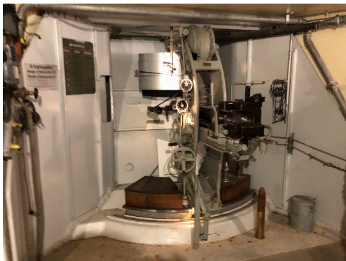
Eine der beiden 7,5 cm Bunkerkanonen mit einer regulären Schussdistanz von 10 km (maximal 14 km).
